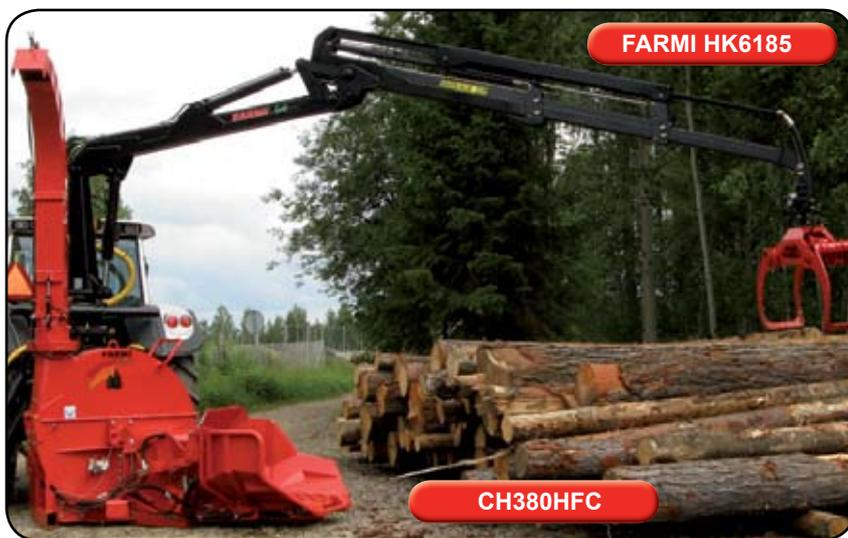
**FARMI 6185 и рубительная установка CH380HFC вместе на тракторе при помощи 3-точечного соединения**
