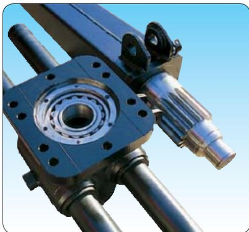
Четыре цилиндра и вращение двойной рамы гарантируют прочность и надежность. Двухрядный (спаренный подшипник) на нижней части разработана для тяжелых лесных работ.
