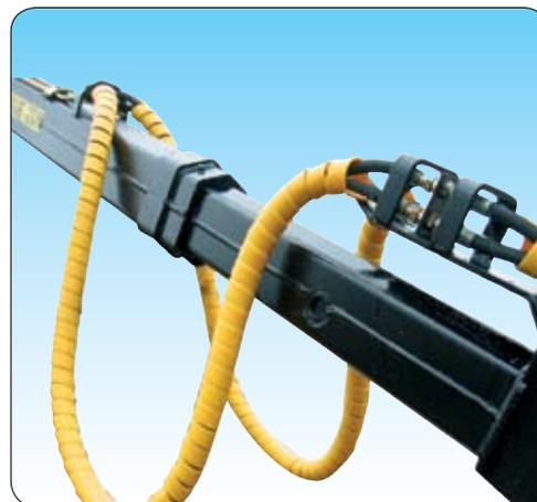
Гексагональные профили стрелы и особый металл обеспечивают превосходные характеристики скольжения и высокой прочности при кручении и изгибе, а также прочности на растяжение.
