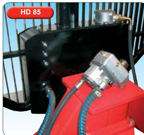
Гидравлическая установка с насосом постоянного или переменного расхода, с емкостью 85 л для управления краном и /или прицепом с 4-х колесным приводом.
